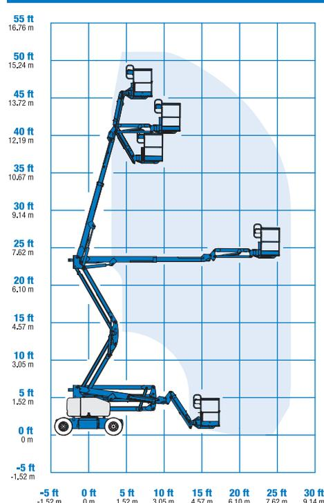
\* Altura de trabajo = Altura de la plataforma + 2 m
